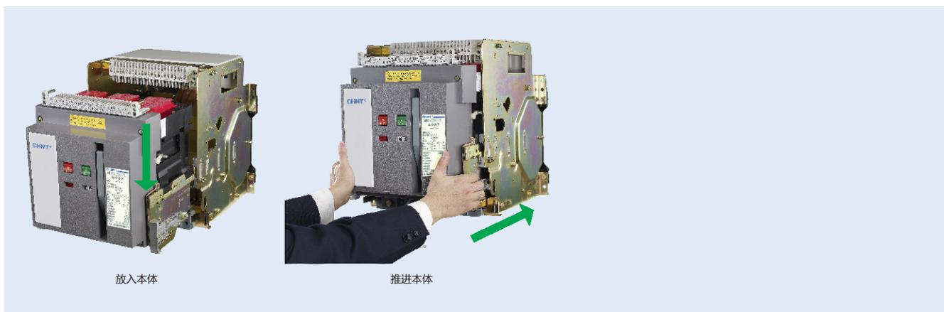
抽出手柄，并将手柄六角头完全插入抽屉座手柄孔内。顺时针转动手柄，直至位置指示器转至“连接”位置，并能听到抽屉座内两侧发出“咔嗒”两声，拉出手柄并放入原位。
