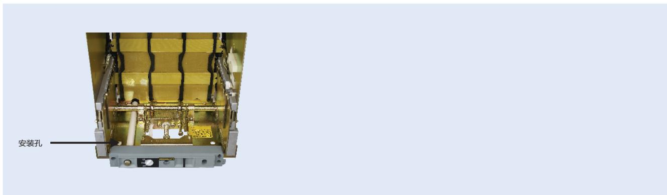
b. 拉出导轨，将隔离开关本体按图所示放置在导轨上，注意隔离开关两凸出支架座应卡入导轨凹槽处，将隔离开关本体向内推入，直至不能推动为止。
